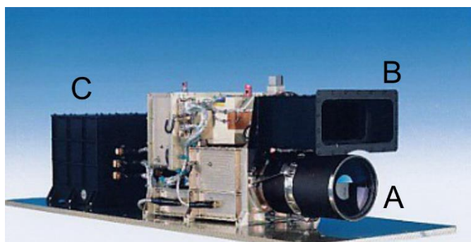
2. ábra: A HRSC eszköz. A) HRSC-SRC B) HRSC színes sztereo szkennert C) Digitális egység forrás: https://www2.mps.mpg.de/images/projekte/mars-express/hrsc/hrsc_b.jpg
