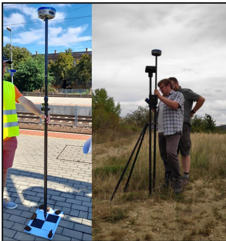
3. ábra: Egy GCP pont lemérése a vasúti terepen RTK-val (balra) és az RTK GPS kalibrálása a kontrolterületen (jobbra).
