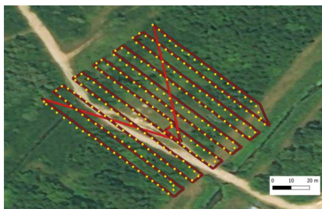
12. ábra: Az UAS (vörös) és a Safecast szenzor (sárga) útvonala összehasonlítva 25 méteres magasságban
