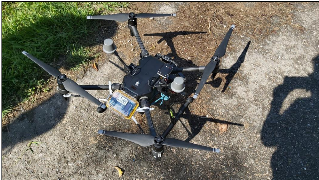
8. ábra: DJI Matrice 210 V2 RTK UAS rögzített Safecast szenzorral a teszterületen
