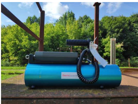
4. ábra: FHZ 672 E-10 szcintillációs detektor a felmérés helyszínén
