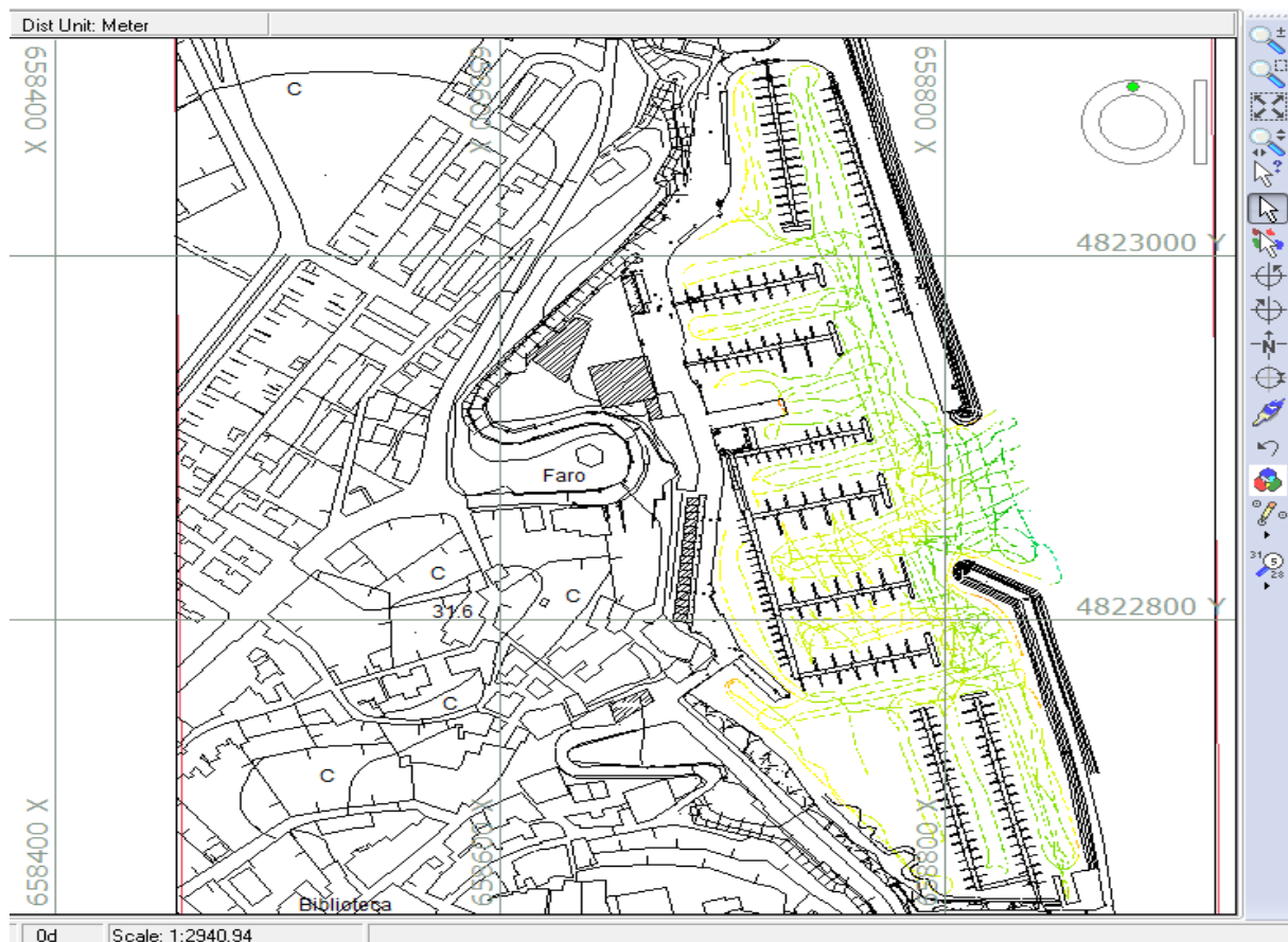
21. ábra: A mérési vonalak megjelenítése a Hypack programmal
