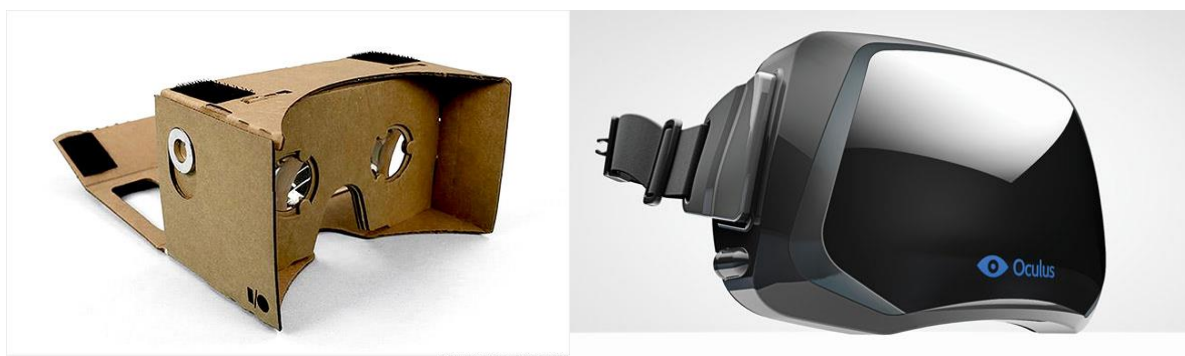
55. ábra. A bal képen egy cardboard látható, melybe okostelefon helyezhető. A jobb oldalon egy Oculus Rift szerepel, melybe nagy felbontású digitális kijelző van beépítve.
