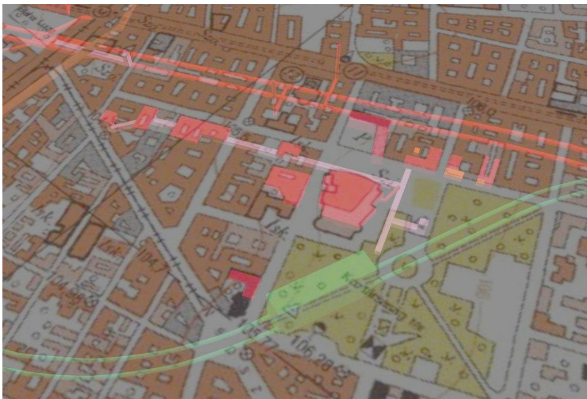
81. ábra. Köztársaság tér felülnézeti képen. Látható a képen a 2-es és 4-es metrók nyomvonala, továbbá a térhez kapcsolódó pincék és az alagút, melynek létezése nem bizonyított.
